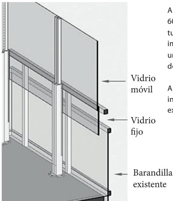
A la izquierda se muestra cómo se monta ClickitUpInside 600 en el interior de una barandilla existente de cobertura total. El ejemplo muestra con barandilla de vidrio. Es importante colocar ClickitUpInside 600 en el interior de una barandilla que esté homologada para una ubicación donde existe el riesgo de desprendimientos.
