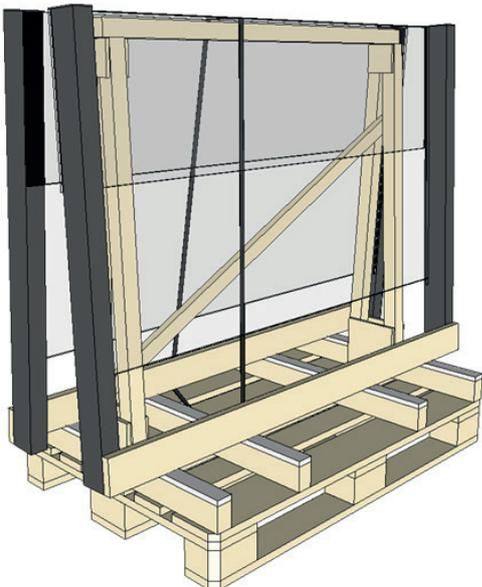
Cada módulo está asegurado individualmente en el embalaje para evitar que ClickitUpInside 600 vuelque durante la descarga.
